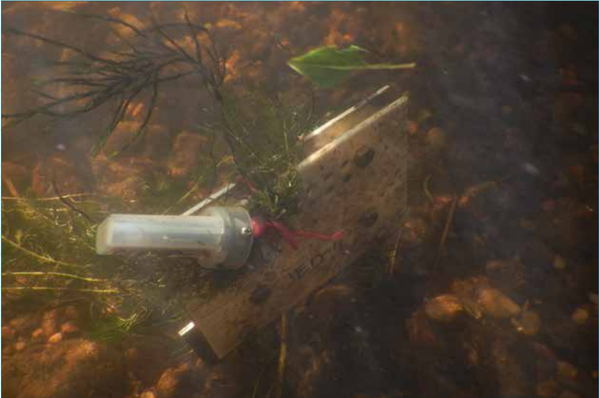
Obr. 51. V toku dlouhodobě instalovaná bioindikační destička se zachycenou makrofytní vegetací.
