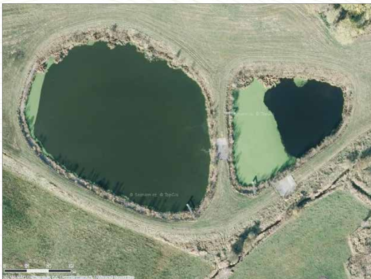
Obr. 82. Letecký pohled na nízkozatěžové biologické dočišťovací rybníčky v obci Zbytiny. Zdroj: Mapy.cz , © Seznam.cz, a. s., © TopGis, s. r. o.
