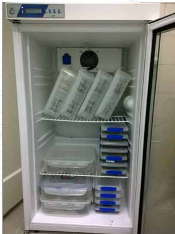
Obr. 66b. Kultivace v termostatu při 19 °C při srovnávacím testu metod (epruvety v šikmé poloze, vpravo dole dózy dle Hruškovy metody, vlevo dole Petriho misky).
