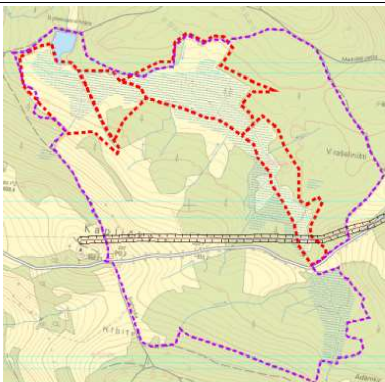
Obr. 7 Situace trasy nadzemního vedení VN označené hnědou barvou
