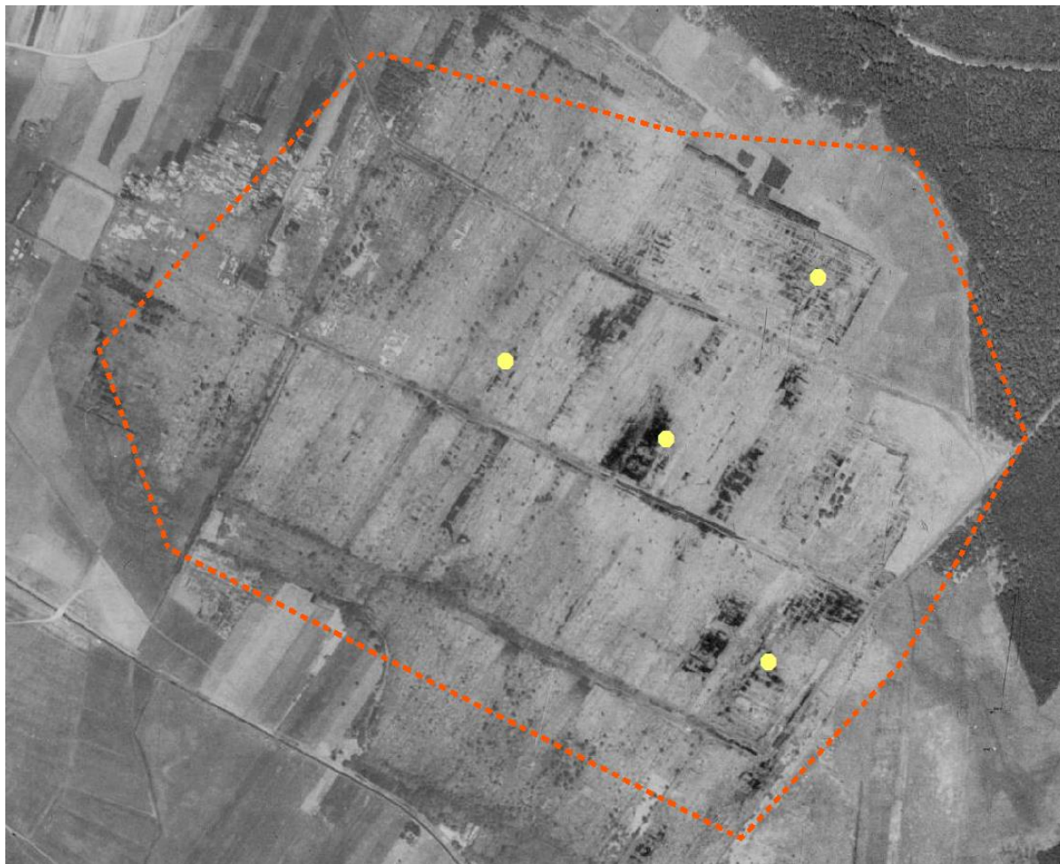
Obr. 20 Rozmístění vrtů se zvýšenou koncentrací amonných iontů a fosforečnanů na podkladu historického leteckého snímku
