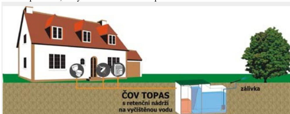
Domovní ČOV se zásobní nádrží na vyčištěnou vodu
