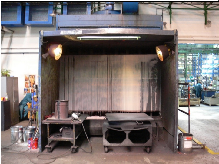
Obr. 3: Stříkací kabina s vodním odlučovacím systémem pro záchyt TZL
