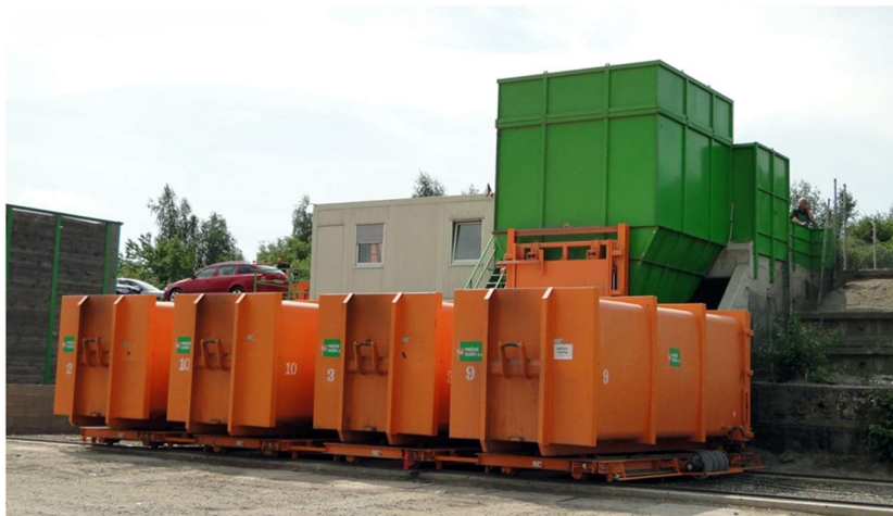
Obrázek 10-3 Jednoduché překladiště - překládací stanice s posunem kontejnerů (Husman)
