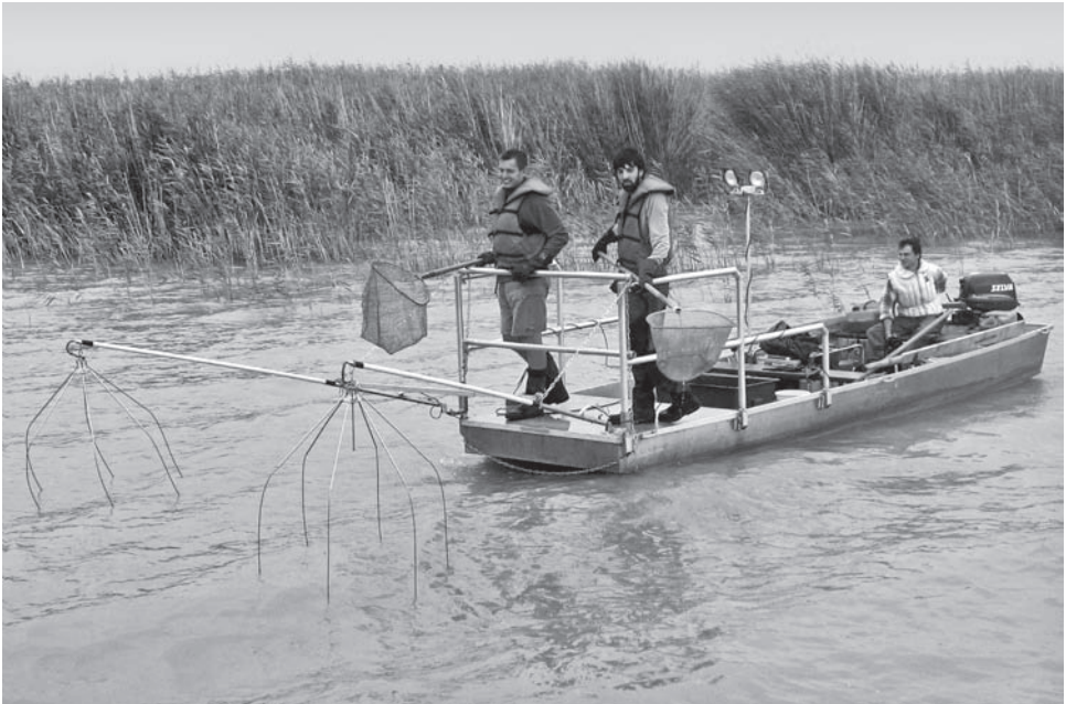
Obrázek 10 – Anody elektrolovné lodě
