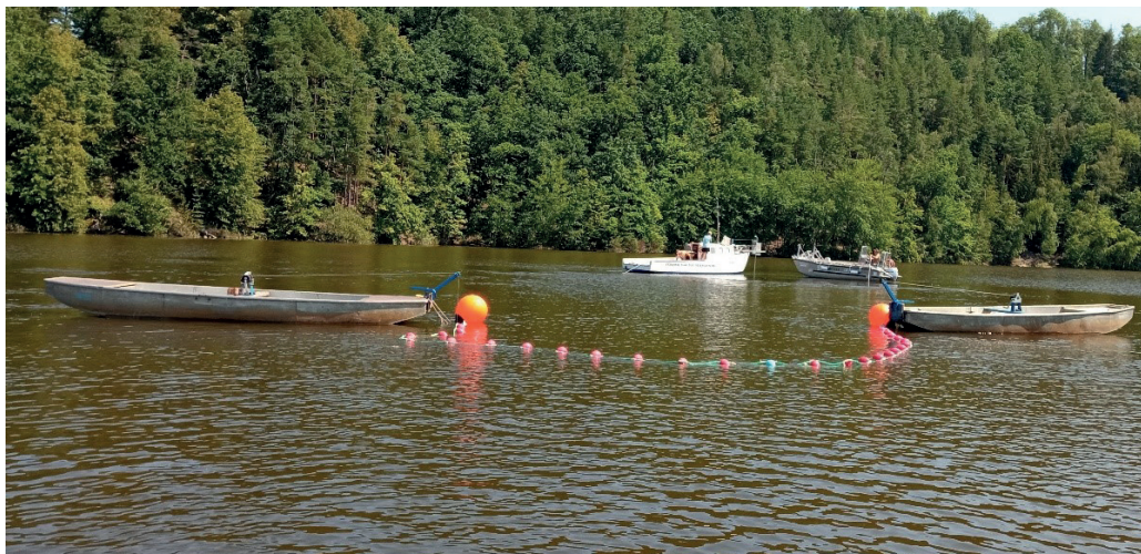
Obrázek 8: Pomocné lodě připevněné v horních rozích tralu s navijáky a lanky vedoucími k závažím ve spodních rozích tralu.
