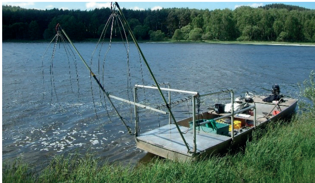
Obrázek 5: Hliníková pramice využívaná jako elektrolovná loď k biomanipulačním odlovům v době tření.
