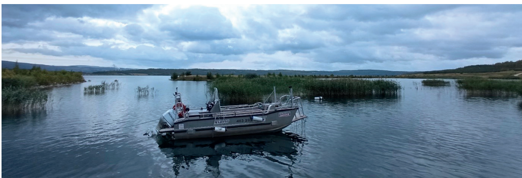
Obrázek 6: Profesionální hliníková elektrolovná loď se zabudovaným agregátem a veškerým elektrolovným vybavením s vestavěnou nádobou na ryby v trupu lodi.
